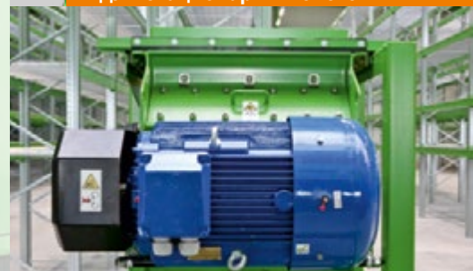
Мощный электродвигатель 45 кВт для производительности до 30 м³/ч
